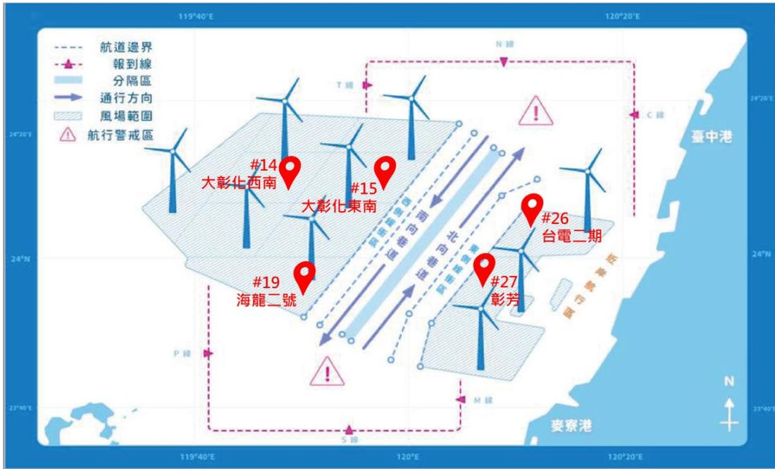
圖 9 離岸風場航道 VTS 系統與離岸風場 AIS/雷達介接之規劃
