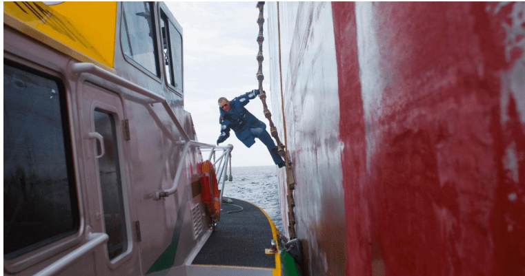
圖 27：引水人登離船裝置示意圖(圖片來源：Marine Insight)
