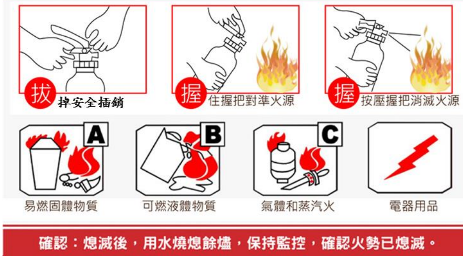
圖 19 攜帶型滅火器使用步驟
